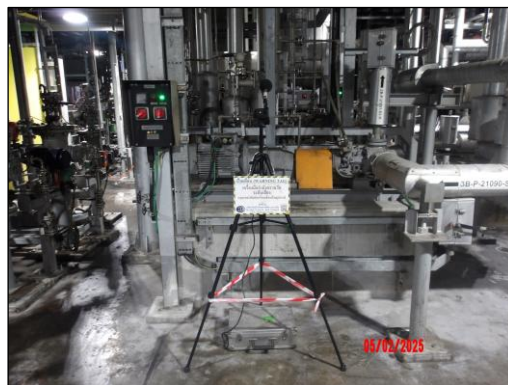
รูปที่ 4.16 การตรวจวัดระดับเสียงในพื้นที่ทำงาน บริเวณ พื้นที่กระบวนการผลิต บริเวณที่ 2
