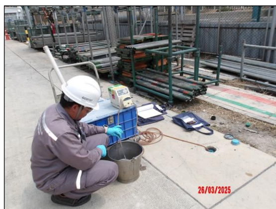
รูปที่ 4.8 การเก็บตัวอย่างคุณภาพน้ำใต้ดิน บริเวณทิศใต้ของพื้นที่โครงการ
