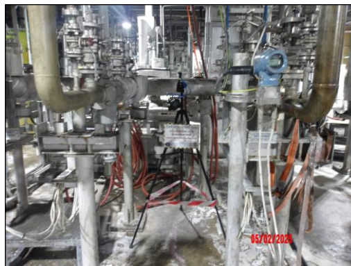
รูปที่ 4.13 การตรวจวัดคุณภาพอากาศในพื้นที่ทำงาน บริเวณพื้นที่กระบวนการผลิต บริเวณที่ 1 (PPG)
