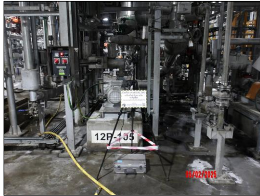
รูปที่ 4.15 การตรวจวัดระดับเสียงในพื้นที่ทำงาน บริเวณ พื้นที่กระบวนการผลิต บริเวณที่ 1
