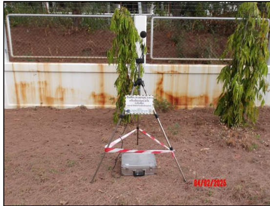
รูปที่ 4.12 การตรวจวัดระดับเสียงโดยทั่วไป บริเวณริมรั้วโรงงานด้านทิศเหนือ
