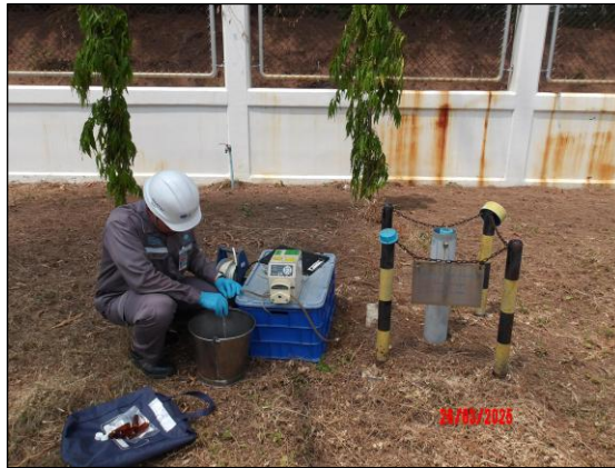
รูปที่ 4.6 การเก็บตัวอย่างคุณภาพน้ำใต้ดิน บริเวณทิศเหนือของพื้นที่โครงการ
